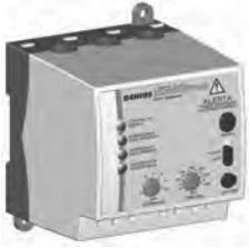
**GENIUS GOC T** supervisa constantemente la corriente del motor y los voltajes de línea. Cuando alguna condición de sobrecarga o falla de fase ocurre, su salida se desactiva manteniéndose así hasta que la falla desaparezca, y/o el motor se haya enfriado completamente.
