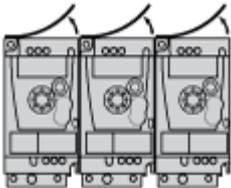
Retire la cubierta protectora de la parte superior de la unidad.
