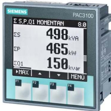
SETRON, aparato de medida, 7KM PAC3100, LCD, L-L: 480 V, L-N: 277 V, 3 fases, Modbus RTU, activa/reactiva, Clase 1 según IEC61557-12 e IEC62053- 21, fuente de alimentación universal, AC/DC, borne de tornillo
