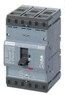
Interruptor automático 3VT1 poder de corte estándar Icu=25kA, 415V AC 3 polos, protección de distribuciones disparador de sobreintensidad TM, LI In=80 A intensidad asignada IR=63...80A protección de sobrecarga II=400...800 A, protección de cortocircuito sin disparador auxiliar sin interruptor auxiliar/de alarma
