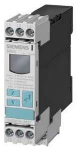
Relé de vigilancia digital para tensión de red trifásica secuencia de fases conectable aditivamente corte de fase 3 x 160 hasta 690 V AC 50 a 60Hz Subtensión y sobretensión 160-690V Histéresis 1-20 V durante 0-20 s para Umín y Umáx 1 CO para Umín 1 CO para Umáx borne de tornillo Producto sucesor de 3UG3041-1BP50
