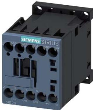
contactor de potencia, AC-3e/AC-3, 9 A, 4 kW/400 V, tripolar, 24 V DC, contactos auxiliares: 1 NA, borne de tornillo, con conectividad
